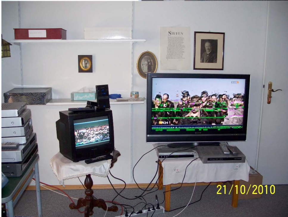
(Abb. 1) Funkversuch Baldern: Massive Störungen beim TV- Empfang im Kabelnetz
